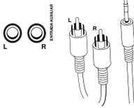
**NOTA:** hacer coincidir el color del cable con la entrada del mismo color, el plug 3,5 mm se conecta al dispositivo de audio.
