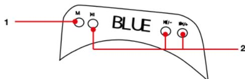
1. MODE. Seleccionar el modo de operación (modo auxiliar, SD / MMC, USB, Bluetooth® o radio), presionar varias veces hasta que en la pantalla se indique el deseado.
