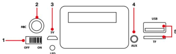
1. INTERRUPTOR ON/OFF. Deslizar para encender o apagar. Presionar para seleccionar el modo de operación (Bluetooth®, radio, tarjeta Micro SD, USB y Auxiliar), presionar varias veces hasta llegar al deseado
