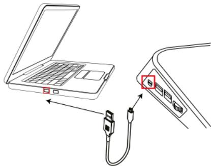
1. Conectar el cable USB del ventilador al puerto USB de la Laptop
